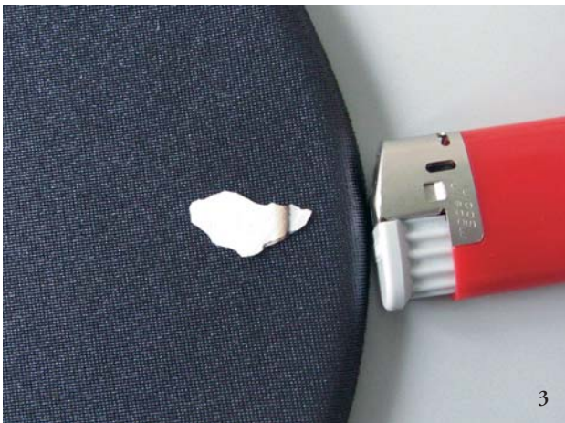
Abbildung 3: Der Malschichtsplitter ist auf der Seite im Bild rechts bis zur grauen Linie in die Feuerzeugflamme gehalten worden. In diesem rechten Teil sind alle in der Farbschicht enthaltenen organischen Bestandteile restlos verglüht. Im grauen Streifen sind die organischen Bestandteile dagegen lediglich verkohlt und links der grauen Zone ist die Probe noch unverändert.
